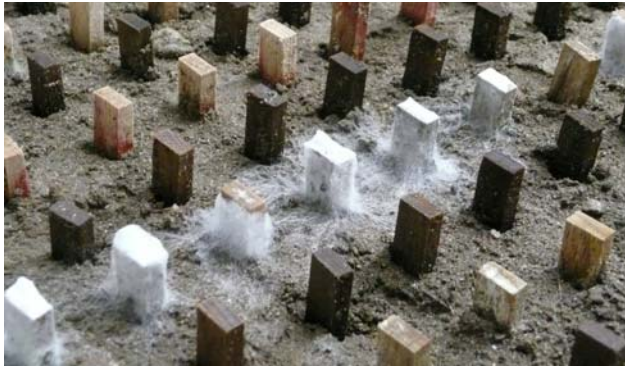
Abbildung 10: Prüfkörper im Erdkontaktversuch gemäß ENV 807
