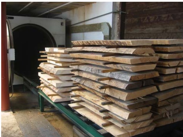
Abbildung 1: Thermoholzbehandlung in einer Kesseldruckanlage des Anlagenherstellers Wood-Treatment-Technology (WTT)
