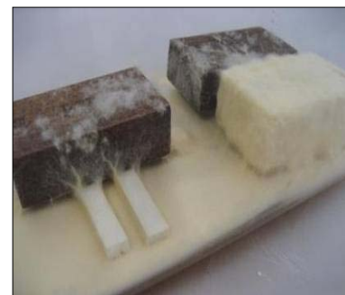
Abbildung 15: Lagerung je eines Behandlungs- und eines Kontrollprüfkörpers in Glascontainern für die Resistenzprüfung in Anlehnung an EN 113
